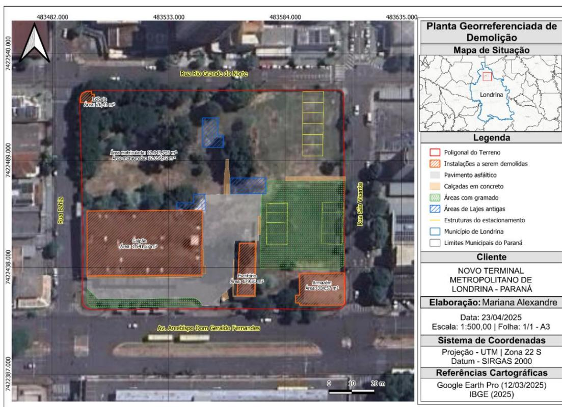
Figura 2 - Planta georreferenciada de Demolição. Fonte: Architectus 2025
