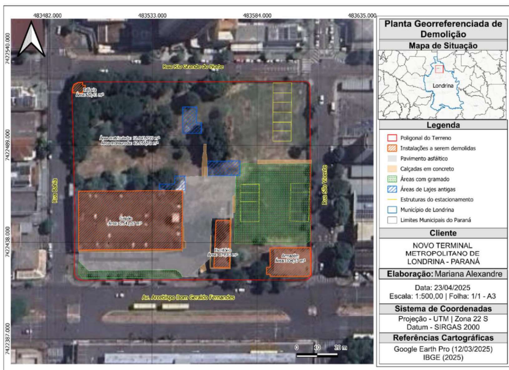
Figura 2 - Planta georreferenciada de Demolição. Fonte: Architectus 2025
